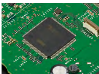
For IF DSP, transmitter ADSP-21363 clock @332MHz
